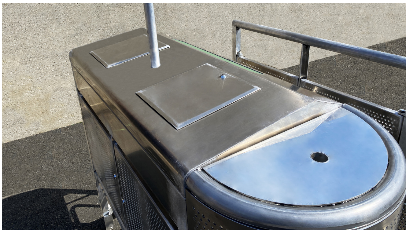
Trappes d'accès à l'électronique sur le dessus, support pour accueillir un petit mât dans le demi-rond.
